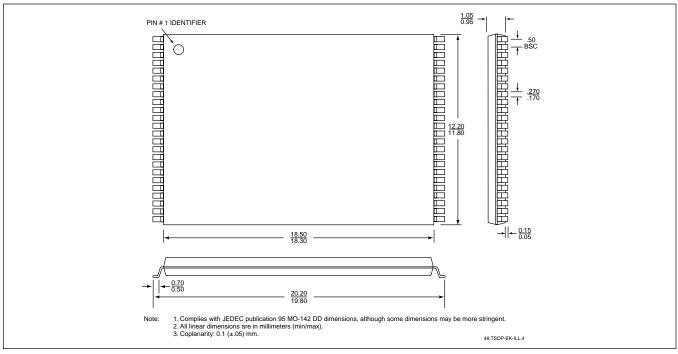
48-PIN THIN SMALL OUTLINE PACKAGE (TSOP) 12MM x 20MM SST PACKAGE CODE: EK
